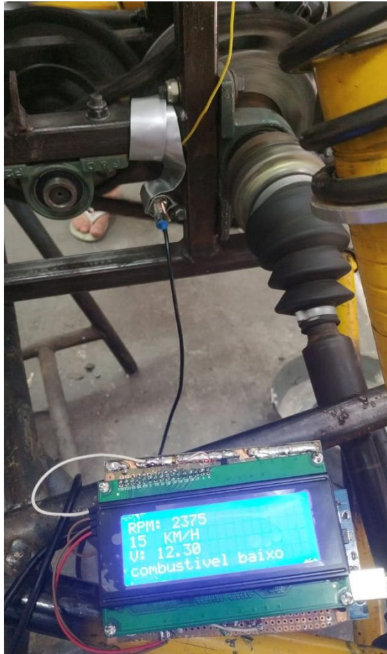
Figura 65 - Teste do Sensor de Velocidade do Veículo Mini Baja
