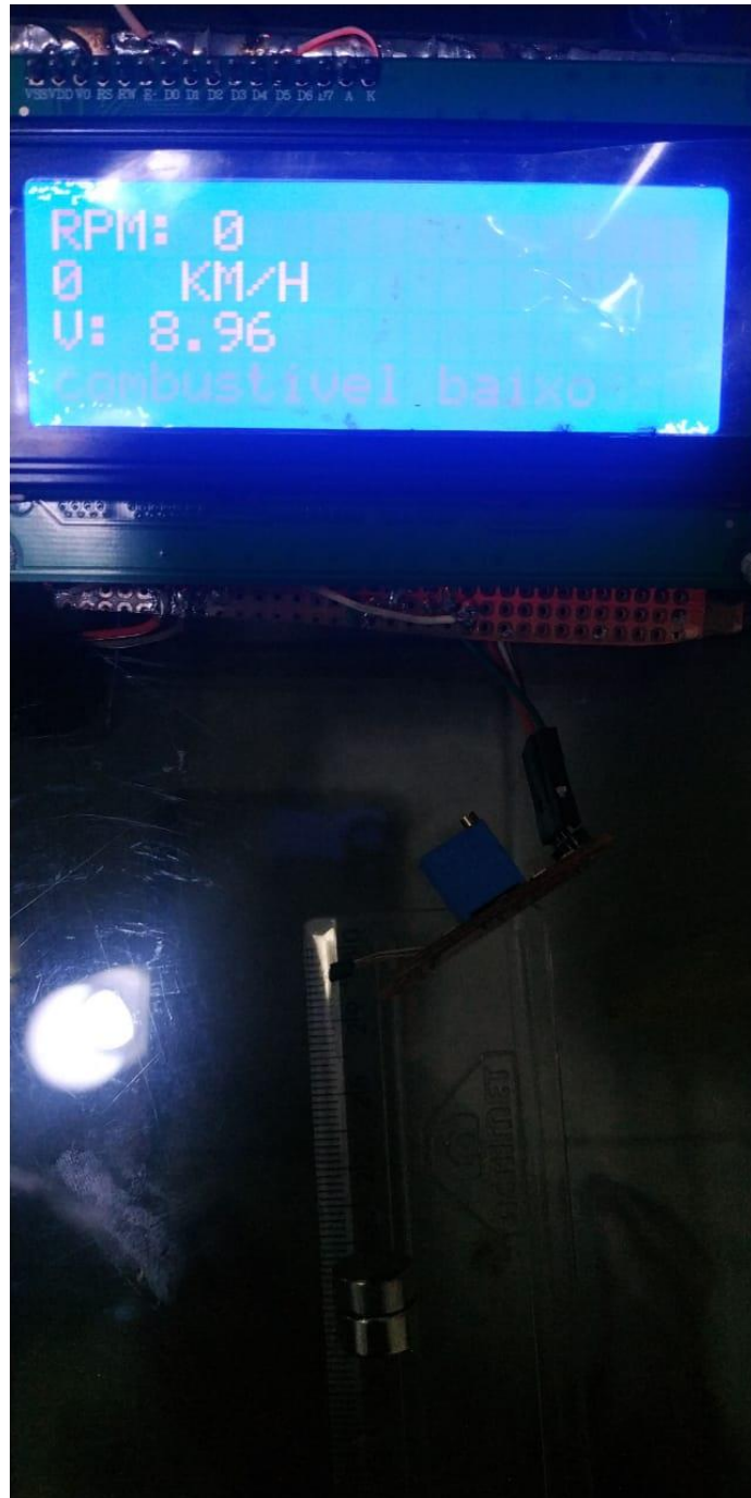
Figura 59 Teste do Sensor de Nível de Combustível
