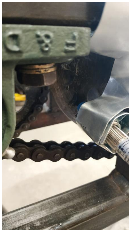
Figura 64 - Montagem do Sensor de Velocidade do Veículo
