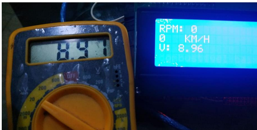
Figura 61 - Resultado do Teste do Sensor de Bateria junto ao Display
