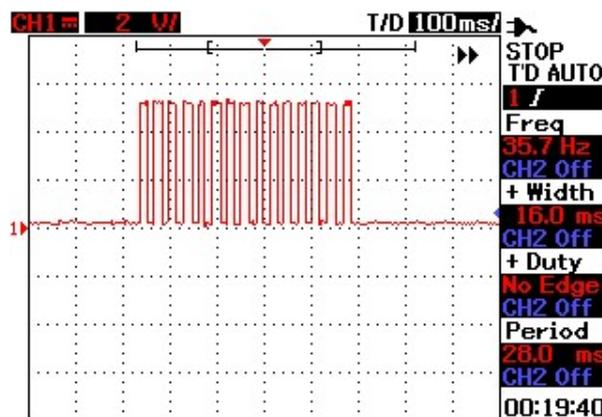
Figura 6 - Recepção de 30 comandos em modo UNICAST.
