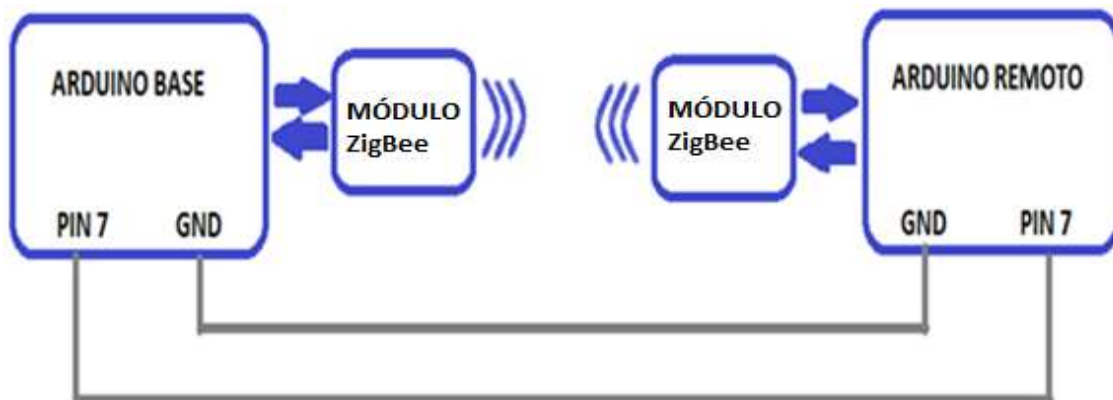
Figura 1- Diagrama de blocos do experimento com módulos ZigBee.
