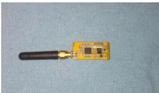
Figura 41 – Vista Superior do módulo de comunicação APC220.
