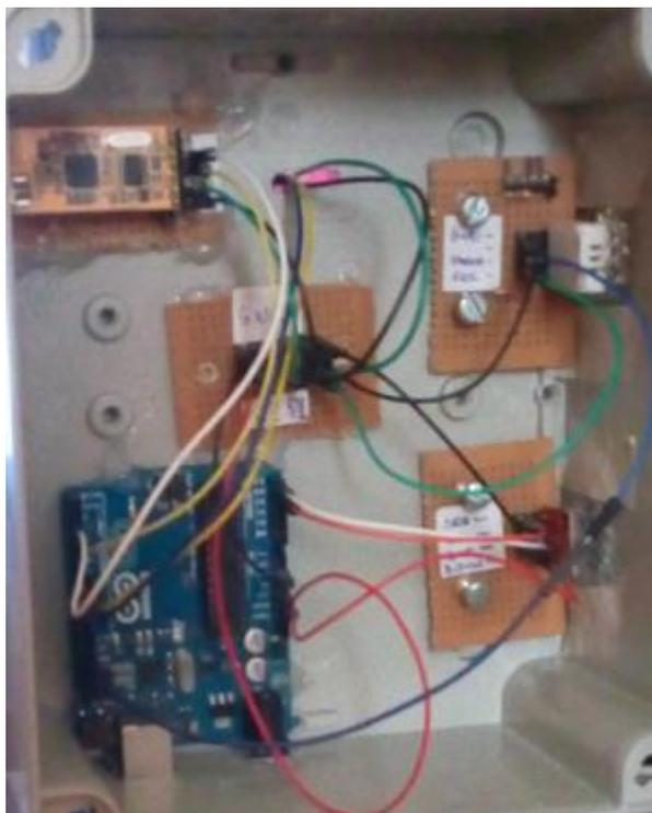
Figura 40 – Interligação do Sensor HC-SR04 com o Arduino instalado no pluviômetro.
