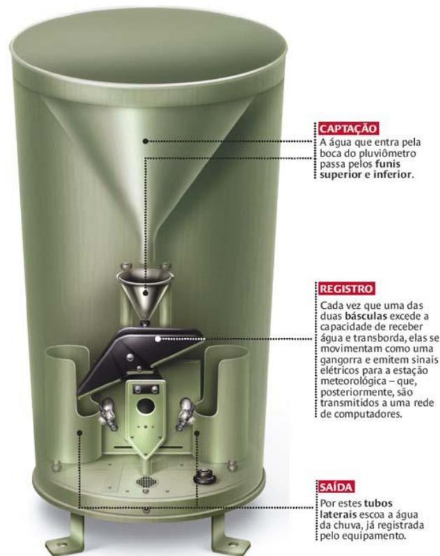
Figura 15 – Pluviômetro do tipo gangorra.
