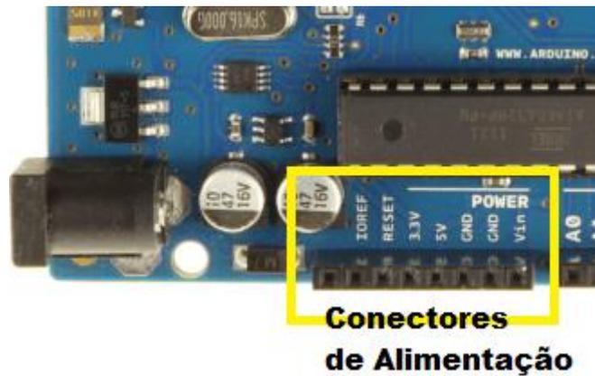
Figura 4 – Conectores de alimentação Arduino UNO.
