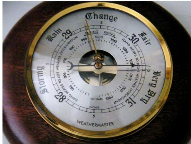
Figura 13 - Barômetro mecânico.
