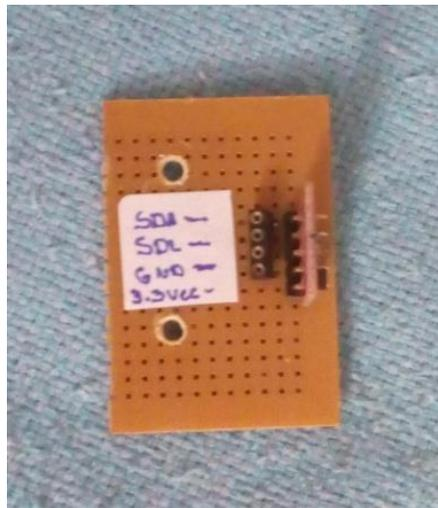
Figura 32 – Vista Superior do Sensor de temperatura e pressão BMP180.
