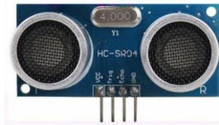
Figura 24 – Sensor de distância ultrassônico HC-SR04.
