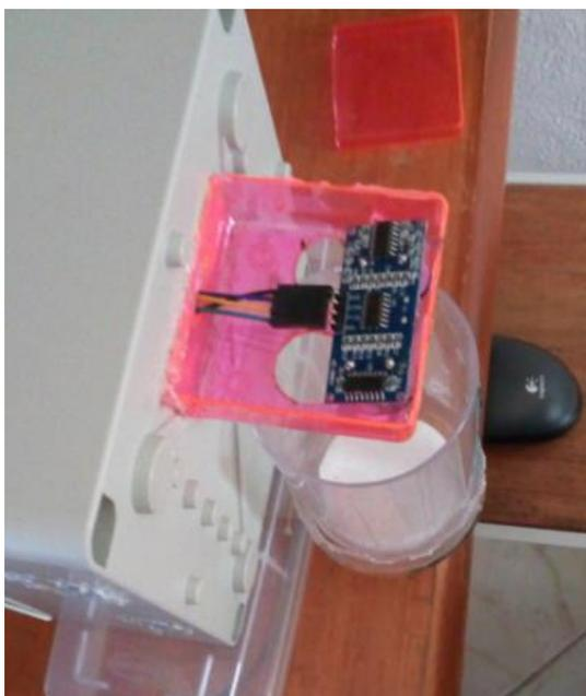
Figura 38 – Vista superior do Sensor de distância HC-SR04 instalado no pluviômetro.
