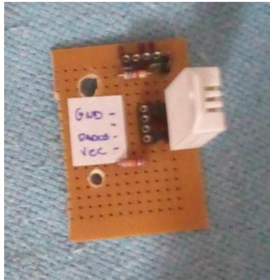
Figura 35 – Vista Superior do Sensor de umidade DHT22.
