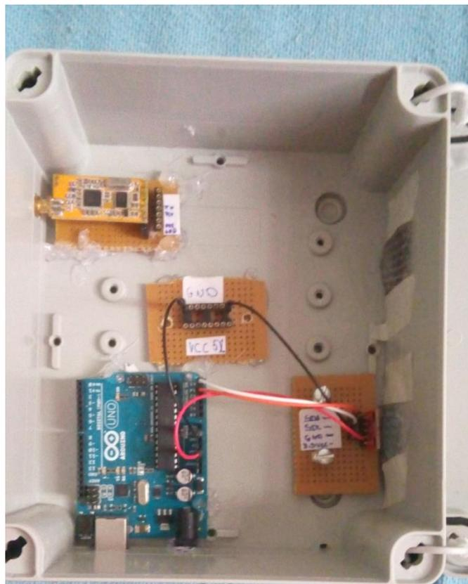
Figura 34 – Interligação do Sensor de temperatura e pressão BMP180 com o Arduino.
