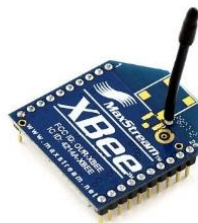
Figura 40 : Módulo XBee , fonte (MAXSTREAM, 2007).
