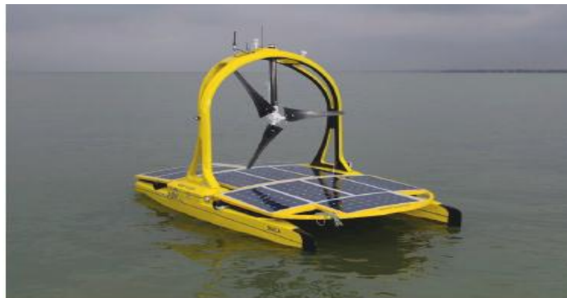
Figura 2: ASV usado na aquisição de dados meteorológicos. (Extraído de http://asvglobal.com/product/c-enduro/ ).
