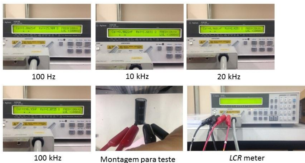
Figura 56: testes dos capacitores eletrolíticos.
