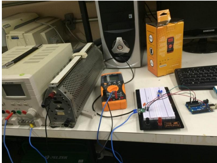
Figura 4 – Circuito de calibração do Sensor de corrente ACS711.
