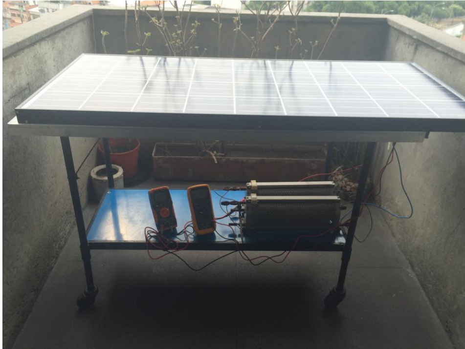
Figura 1 – Foto do sistema experimental para a medição das características do painel fotovoltaico.
