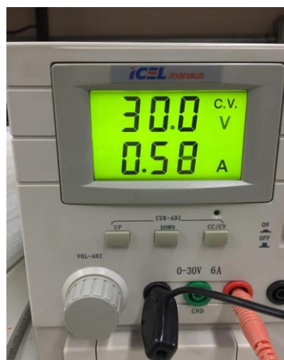
Figura 5. 7: Tensão de Alimentação de 30V na Câmera Speed Dome.
