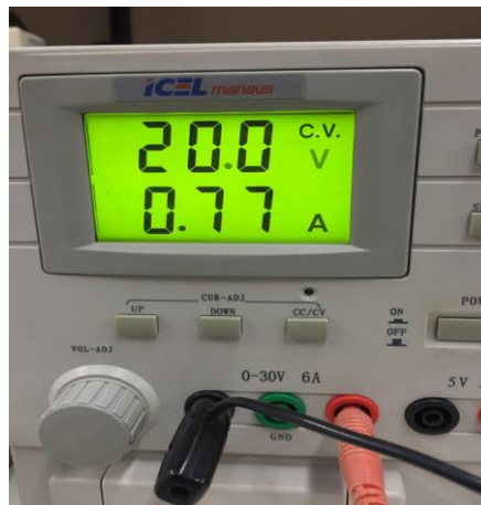
Figura 5. 6: Tensão de Alimentação de 20V na Câmera Speed Dome.
