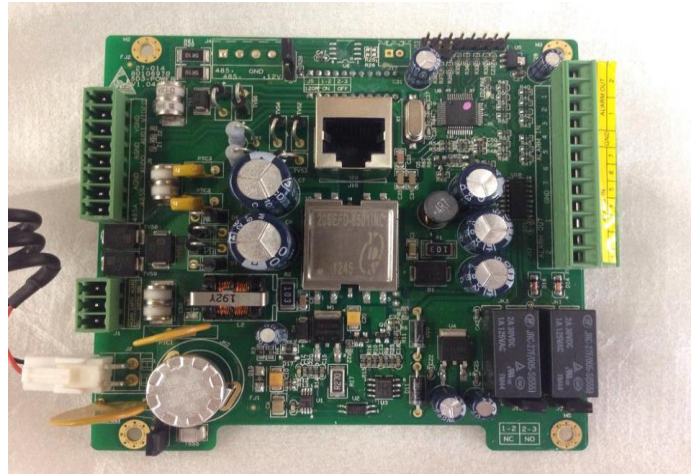
Figura 5. 4: Placa Responsável por Receber a Alimentação e a Comunicação da Speed Dome .
