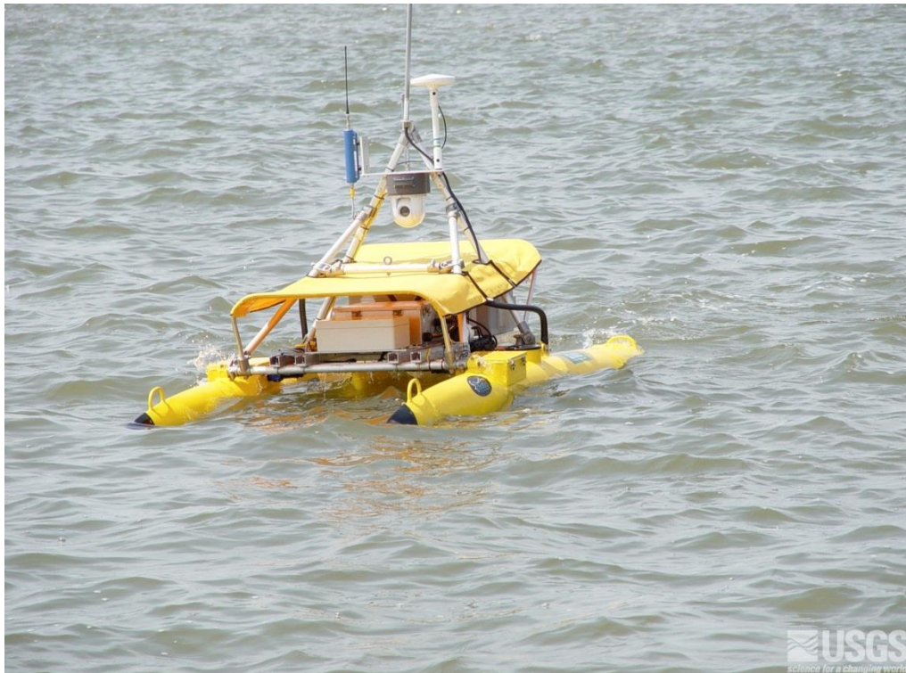
Figura 1. 2: Embarcação não Tripulada Fabricada pela Hole Science Center .
