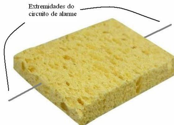
Figura 3.3: Esquema do sensor de inundação.
