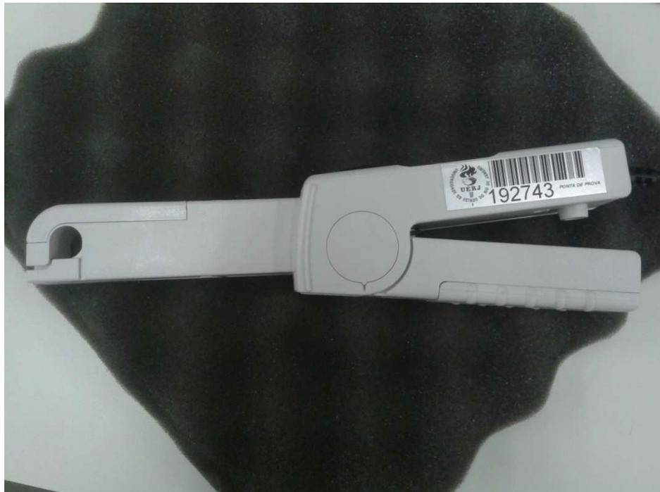
Figura 38: Ponteira para medição de corrente utilizada nos teste.
