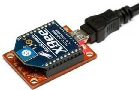
Figura 26: Xbee Explorer.
