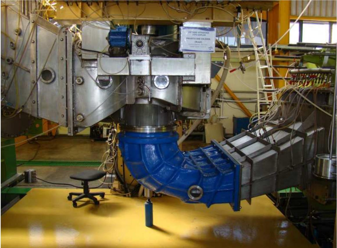
Figura 3: Modelo reduzido de uma turbina da UHE Colíder.
