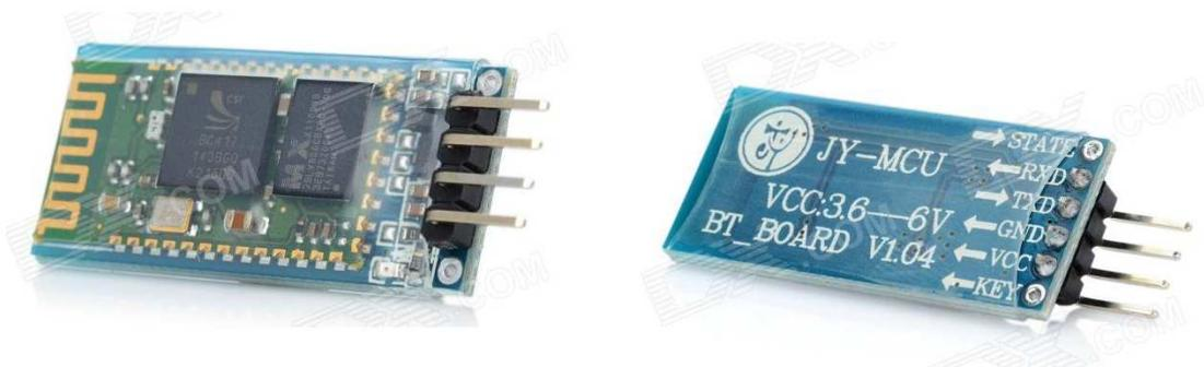
Figura 16: Módulo Bluetooth para uso em microcontroladores.
