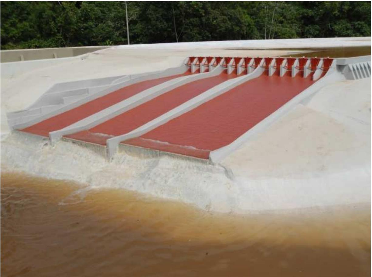
Figura 2: Modelo reduzido do vertedouro da usina hidrelétrica de Itaipú.
