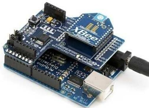
Figura 24: Arduino com Xbee shield.
