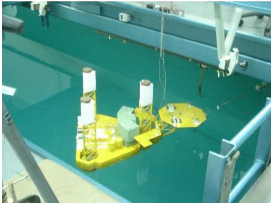
Figura 1: Exemplo de uso de modelo reduzido: modelo de uma plataforma para exploração de petróleo em um tanque.
