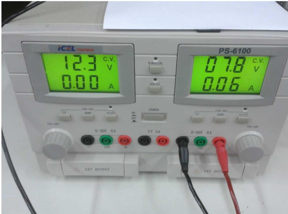
Figura 39: Fonte de tensão utilizada para alimentar o *driver* dos motores para os testes.
