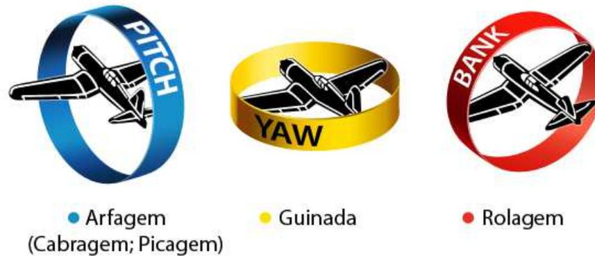
Figura 11: Representação dos eixos de orientação.
