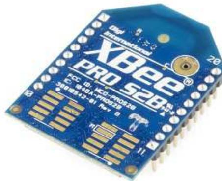
Figura 23: Xbee com antena PCB.
