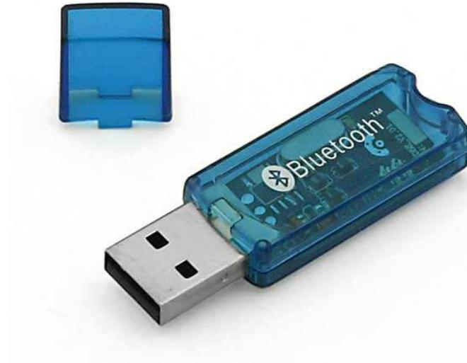
Figura 17 Bluetooth Dongle para o computador.
