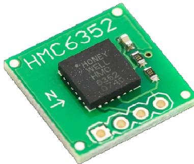
Figura 7: Bússola eletrônica HMC6352 da Honeywell.
