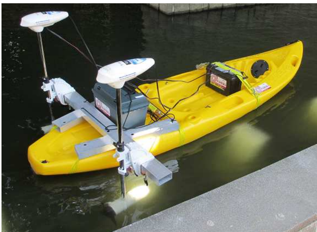
Figura A.3 – arranjo motores mais suporte metálico fixados no caiaque.
