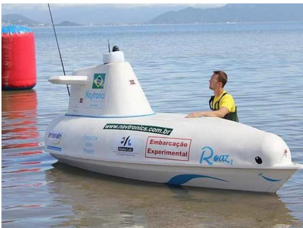
Figura 1.3 – Embarcação não tripulada ROAZ 1 desenvolvida pelo Engenheiro Roberto Böell Vaz para o monitoramento ambiental. Imagem extraída de [20].
