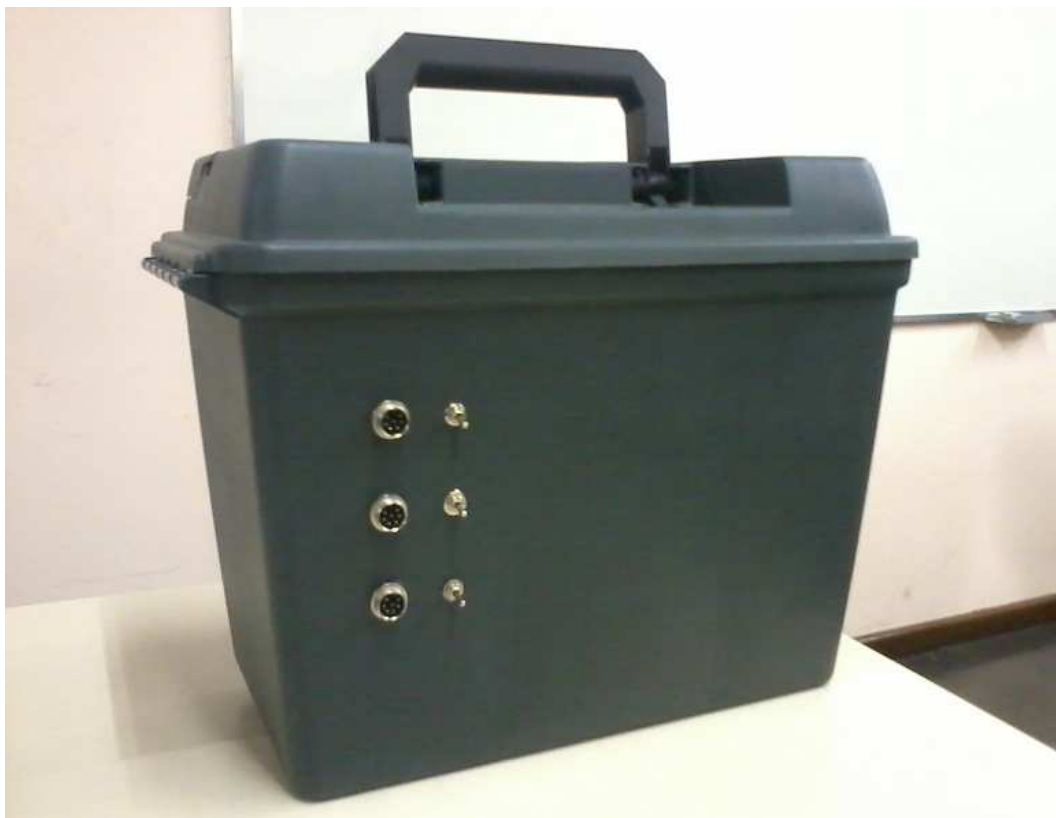
Figura A.4 – Caixa estanque do sistema de controle.
