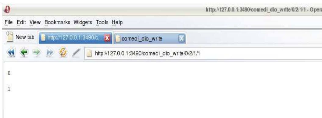
Figura 3.6: Detalhe da chamada ao servidor local para escrita de bit na porta paralela.
