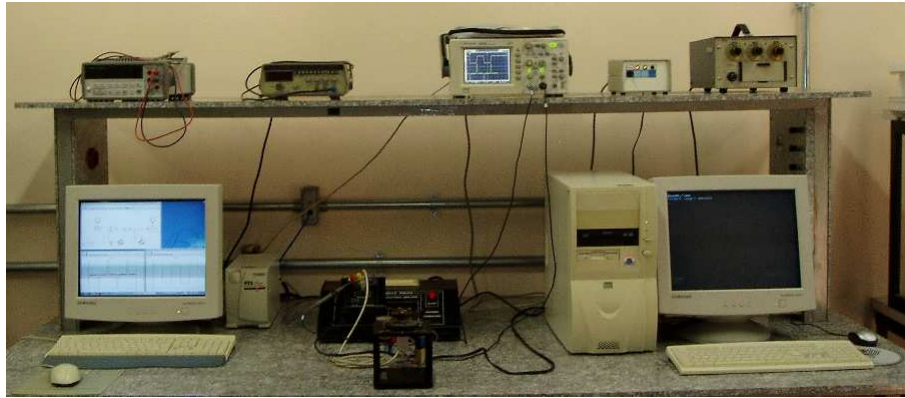
Figura 4.1: Bancada para os experimentos de controle. O computador cliente, à esquerda, executa o Scilab/Scicos. No centro está o servomecanismo e à direita está o computador servidor, que hospeda a placa de aquisição de dados.
