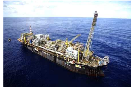
Figura 1.2: Plataforma do tipo FPSO
