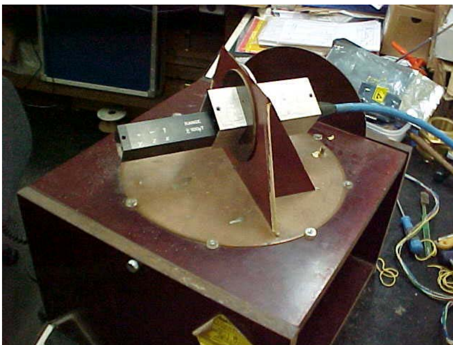
Figura 27: Utilização do Magnetômetro Tria-Axial de referência junto à Giga de posicionamento giroscópio
