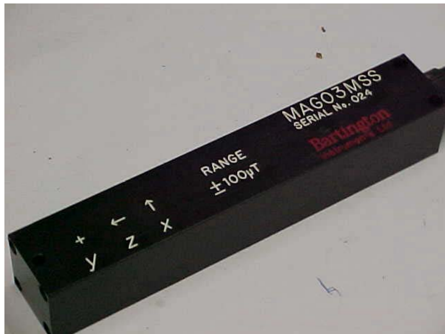
Figura 25: Magnetômetro Tria-Axial de referência
