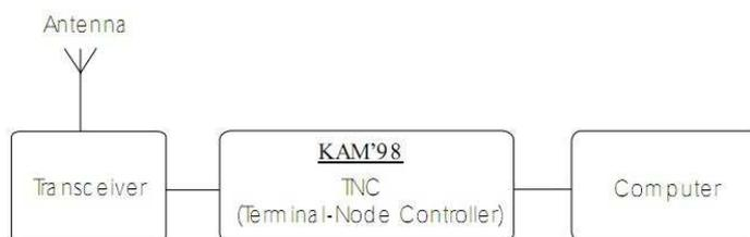
Figura 2: Esquema de utilização de TNC
